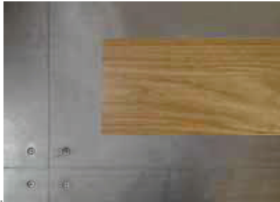
Figura 2: Localización de una lama de 150 x 1000 mm, para ser desplazado 75 mm y 100 mm de los bordes de un panel de suelo elevado.
